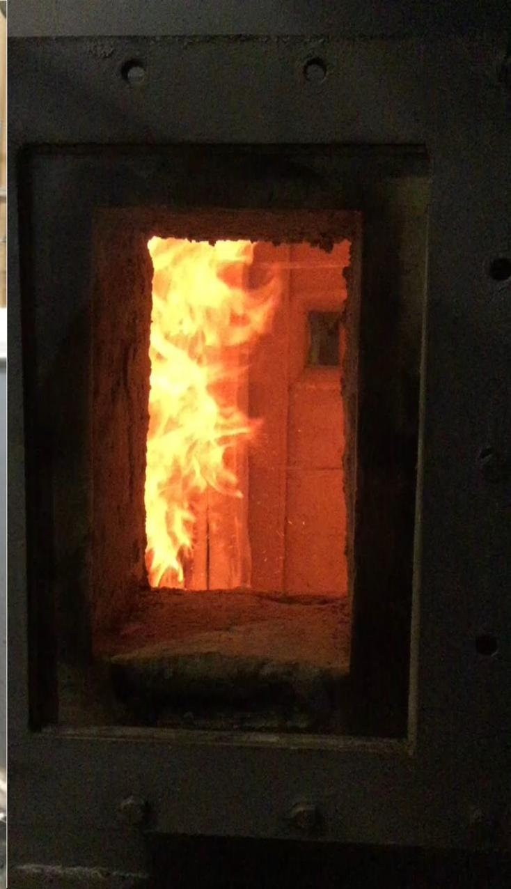
**1時間準耐火** 性能評価試験（外断熱仕様 平成29年3月国土交通大臣認定取得）
